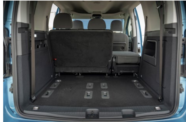
Złożone tylne oparcie w części foteli w 2. rzędzie i wymontowane fotele 3. rzędu
